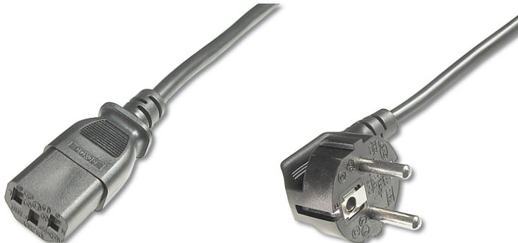
**Netzanschlusskabel, CEE 7/7 (Typ-F) 90Ø gew.- C13 St/Bu, 0,75m, H05VV-F3G 0.75qmm, schwarz**
