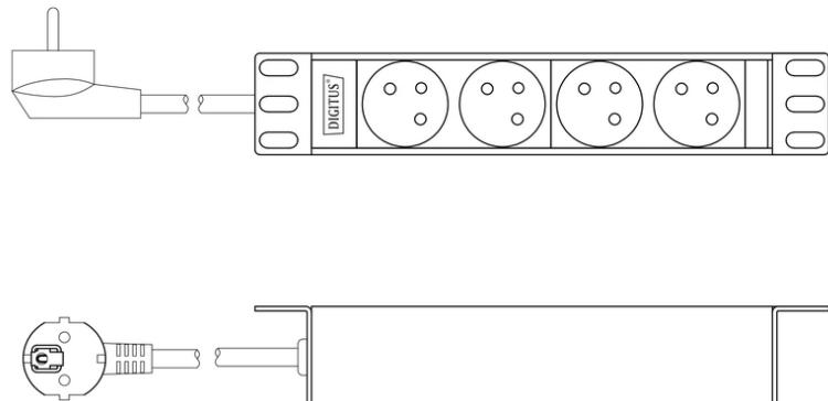
**1U-Aluminium-PDU, 254 mm (10") Rack-Montage, 4x CEE 7/5 Steckdose, 16A, 4000W, 250VAC 50/60Hz**
