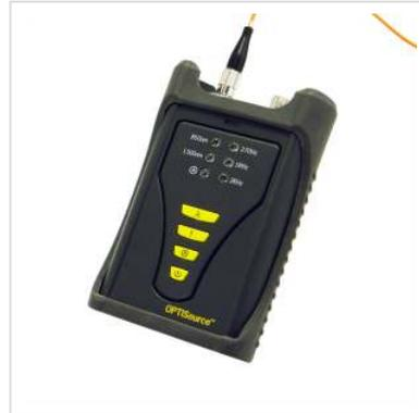
**Diese optische Laserlichtquelle ist eine stabilisierte Hochleistungslichtquelle, die im Bereich der Fiberglas Netzwerkinstallation und Wartung Anwendung findet. Der Anwendungsbereich der OPTISource Doppelwellenlänge MM 850nm / 1300nm LWL-Lichtquelle liegt dabei, durch seine hochwertige Verarbeitung und Zuverlässigkeit, im Bereich der fiberoptischen Dämpfungsmessung, der fiberoptischen Signalverlust-Messung und der Fiberglas Kabel Identifikation über Lichtquellen Modulation.**
