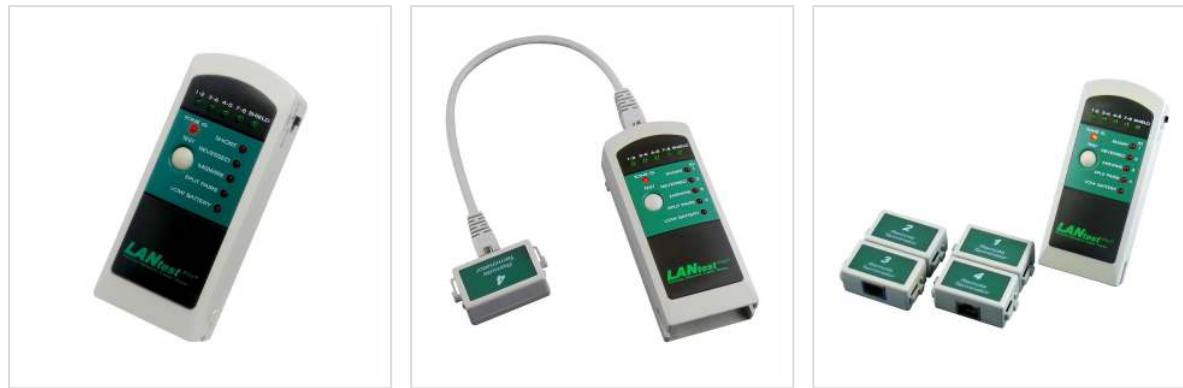
**Der LANtest Pro - Netzwerkkabeltester mit Tongenerator ist ein kleines handliches Testgerät, das es dem Benutzer ermöglicht, schnell den Zustand von Ethernet Twisted Pair Kabeln anzuzeigen. Es ermittelt sekundenschnell Fehler wie offene, kurzgeschlossene, gekreuzte, gedrehte Kabelpaare sowie Split Pair Fehler. Mit der Tongenerator-Funktion kann der Techniker ein Signal durch die verlegten Kabel senden und mit dem Cable Tracer dann den Fehler lokalisieren.**
