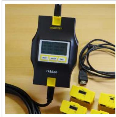
**Der INNOTECH Modularer Kabeltester ist die neueste Innovation der Prüftechnik auf dem Markt. Es ist der erste Tester seiner Art im Moduldesign. Er arbeitet mit austauschbaren Modulen, sodass immer der benötigte Anschluss vorhanden ist. In dieser Version kommt er im Koffer zusammen mit 4 Modulen zum Test von HDMI-Kabeln**
