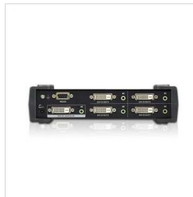
Der 4-Port-DVI-Splitter (Dual Link) mit Tonübertragung VS174 vereint die DVI-Qualität in Sachen Bild und Ton, indem er die Signale einer Bild- und Tonquelle an vier A/V-Ausgängen zur Verfügung stellt. Dieser Bildsignal-Splitter besitzt eine Dual Link-Schnittstelle, wodurch eine hohe Bandbreite für mehr Sendeleistung und schnellere Bildfrequenzen gewährleistet ist. All dies führt zur verbesserten Bildqualität bei Auflösungen von bis zu 2560 x 1600 Pixel.
