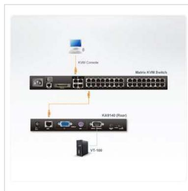
Les adaptateurs pour CPU série d'Altusen permettent de connecter les câbles KVM aux ports série des serveurs. Ces adaptateurs légers et peu encombrants trouvent parfaitement leur place dans la plupart des serveurs sur bâti et de bureau.
