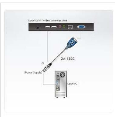
L'émulateur EDID VGA 2A-130G est conçu pour les installations de systèmes d'extension KVM ou vidéo ATEN qui n'utilisent pas de moniteur local sur le site où l'ordinateur ou la source vidéo est installé(e). Le 2A-130G émule et enregistre des données EDID (Extended Display Identification Information) par défaut d'ATEN dans une mémoire non volatile. Cela signifie que l'ordinateur/la source vidéo peut toujours « voir » l'écran d'affichage, même si ce dernier n'est pas connecté directement.
