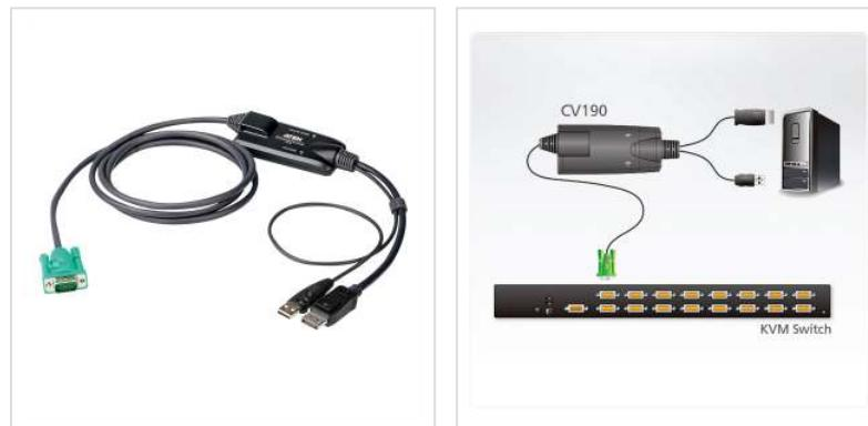
Le CV190 est un convertisseur de console DisplayPort. Il prend entièrement en charge les commutateurs KVM ATEN qui utilisent des connecteurs spéciaux haute densité à 15 broches (SPHD-15) spécialement conçus pour transmettre les données KVM entre le commutateur et l'ordinateur.
