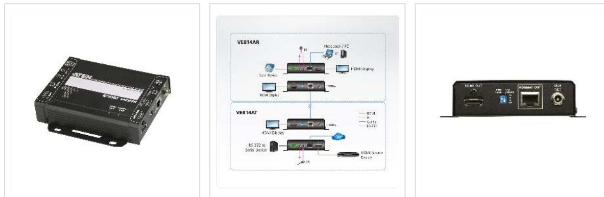
**L'ATEN VE814AT est un émetteur vidéo HDBaseT pouvant transmettre les signaux HDMI jusqu'à 100 m sur un seul câble Cat 5e/6/6a ou ATEN 2L-2910 Cat 6. Doté de deux sorties synchrones, le VE814AT peut transmettre le signal vidéo à deux affichages distants et un sur le côté local. Cet émetteur compatible HDCP 2.2 répond aux spécifications HDMI, y compris 3D, Deep Color, au débit de données maximal de 10,2 Gbps et à la qualité vidéo 4K jusqu'à 100 m.**
