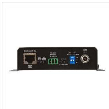
Ausgestattet mit der leistungsstarken HDBaseT-Technologie der Class A ist der VE2812PR ein Empfänger für 4K-HDMI-Video-, Audio- und Steuersignale über eine Entfernung von bis zu 100 m über ein Cat 5e- / 6- / 6a- oder ATEN 2L-2910 Cat 6-Kabel. Die HDMI-Signalübertragung reicht bis zu 150 m bei 1080p, wenn der HDBaseT Modus für lange Reichweite aktiviert ist.
