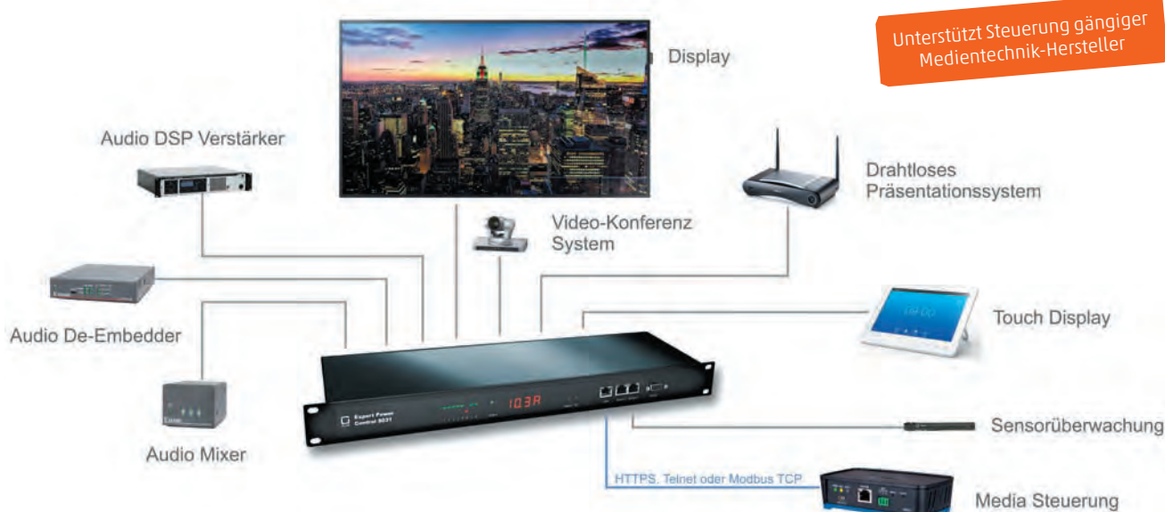
Einsatz des Expert Power Control 8031-3 am Beispiel eines Konferenzraums
