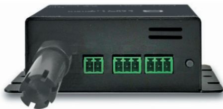
Oberseite der Expert Sensor Box 7214-Serie : Industrieklemmen-Anschlüsse für Relaisausgang, Signaleingang und redundante Stromversorgung
