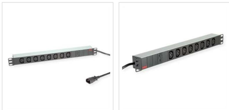
**19" Steckdosenleiste mit 8x C13 Anschlüssen und Zuleitung (2m) mit C14-Stecker, 10A gesichert, 1HE, zum Einbau in 19" Schränke, inkl. Einbauwinkel.**
