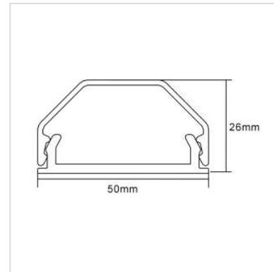
**ROLINE Kabelkanal aus leichtem, soliden Aluminium - einfach zu öffnen für schnelle und einfache Anpassbarkeit.**
