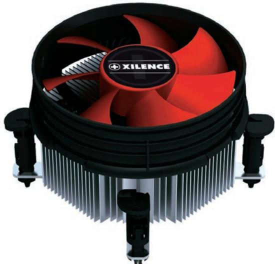
Der LGA 1156 von Xilence - bekannt für leise PC-Komponenten und exzellentes Preis-Leistungs-Verhältnis - sorgt mit seinem hohen Luftdurchsatz für effiziente Kühlung leistungsfähiger CPUs. Der rote 92mm Lüfter ist dank Hydro Bearing und PWM-Steuerung äußerst leise. Der Kühler ist geeignet für Core i7/i5/i3 und Pentium G9650.
