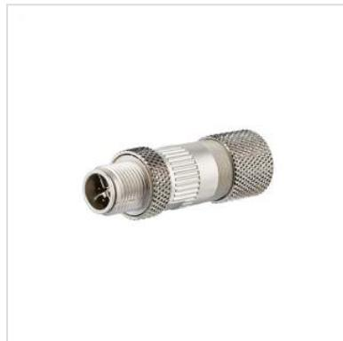
Feldkonfektionierbarer M12-X Cat.6a Stecker; 10GBit geeignet nach IEEE 802.3an; geeignet für POE; 8adriger M12-Stecker für AWG22; Anschluss von AWG 26/7-22/7; AWG 24/1- 22/1 möglich; Volldraht CU-Leiterdurchmesser 0,4-0,64mm; Litze CU-Leiterdurchmesser 0,48-0,76mm; Aderdurchmesser bis 1,6mm; Kabelmantel 5,0 bis 9,7mm; besteht aus 2 Teilen; einfachste Konfektionierung ohne Spezialwerkzeug; industrietaugliches Zinkdruckgussgehäuse
