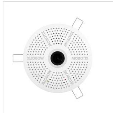
**Die Mobotix c26B ist die kleinste hemisphärische Kamera im Programm und bekannt für die schnelle Deckenmontage im Innenbereich. Die Kamera hat einen lichtstarken Tag- oder Nachtsensor mit 6Megapixel und MxAnalytics Videoanalyse, z. B. für Heatmap um die Kundenwege in Verkaufsräumen zu analysieren. Mit dem Zubehör IO-Modul (MxIOBoard-IC) erhält die Kamera zusätzlich einen MxBus-Anschluss, zwei Eingänge und zwei 12V-Ausgänge.**
