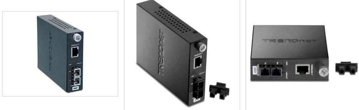
Der intelligente Glasfaserkonverter TFC-1000MSC kann als Einzelgerät oder in Kombination mit dem Systemgehäuse TFC-1600 verwendet werden. Dieser multi-modus-SC-Glasfaserkonverter unterstützt SNMP und eignet sich für Entfernung bis zu 550 m. Er ist mit einem 1000Base-T-Port (RJ-45) und einem 1000Base-SX-Port (SC) ausgestattet.
