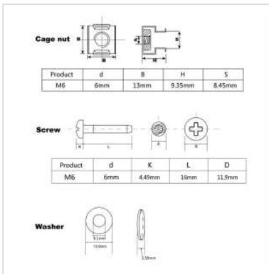
**19"-Befestigungssatz, 100er Set (Schraube, Scheibe, Mutter). Zur Montage von Frontplatten oder Verteilerfeldern an Winkelprofilen oder Tiefenstreben mit Rechtecklochung.**
