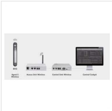
**Der Agent E Wireless Schwenkgriff kommuniziert mittels Funknetz. Aufgrund seiner kabellosen und damit kostensparenden Montage ist er bestens zum Nachrüsten in Rechenzentren geeignet. Die Authentifizierung erfolgt über RFID. Ein hocheffizientes Energiemanagement garantiert eine lange Batterielebensdauer.**
